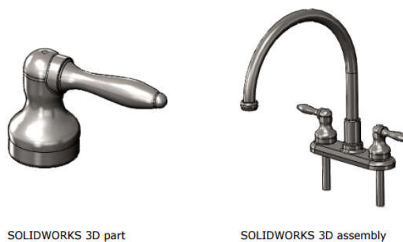
Slika 21: Solidworks 3D parametarski model i sklop
