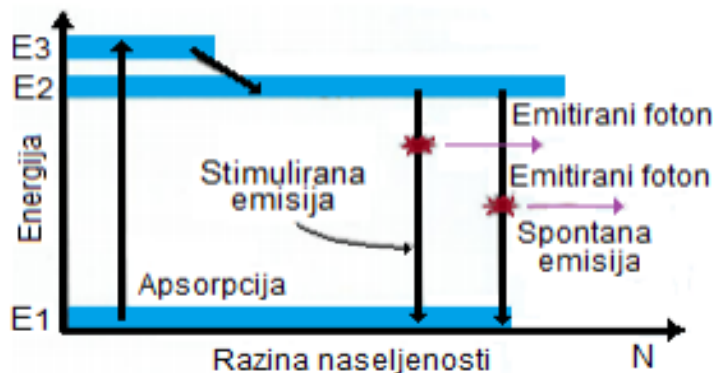
Slika 8. Prikaz lasera s tri energetske razine 15
