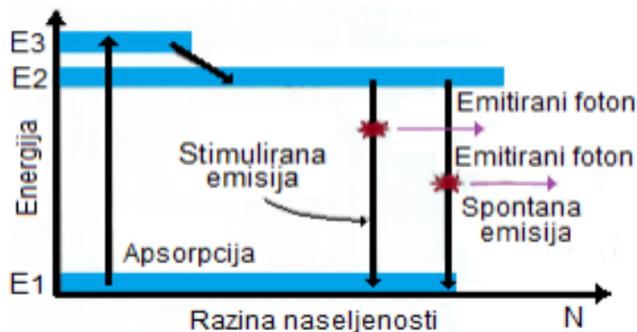
Slika 8. Prikaz lasera s tri energetske razine 15
