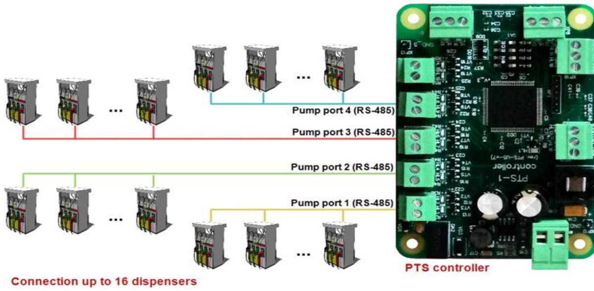
Slika 18 : Shema povezivanja PTS upravljača sa agregatima, Izvor:<sup>49</sup>
