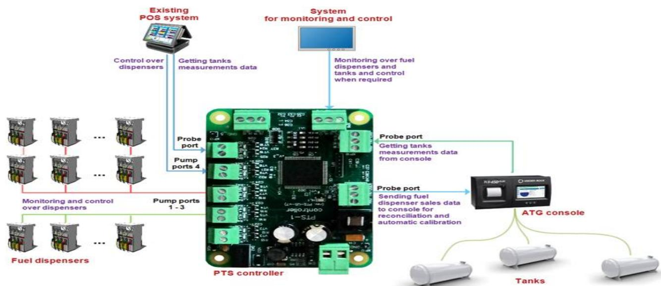
Slika 20 : Shema protokola između agregata, pos sustava i sondi goriva,Izvor:<sup>55</sup>
