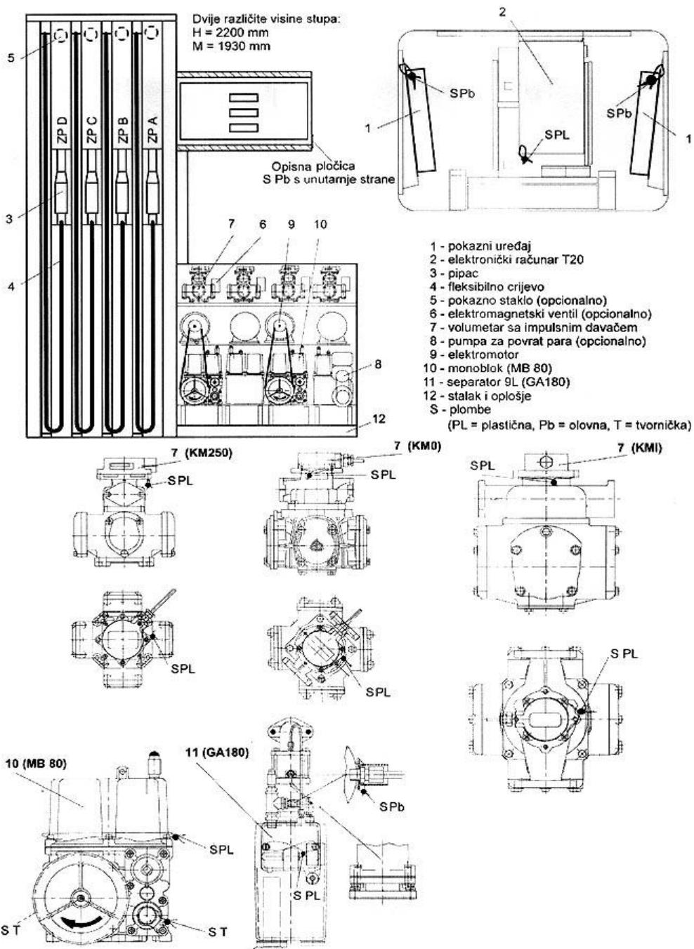
Slika 13: Shema plombiranja mjernog uređaja, Izvor:<sup>36</sup>
