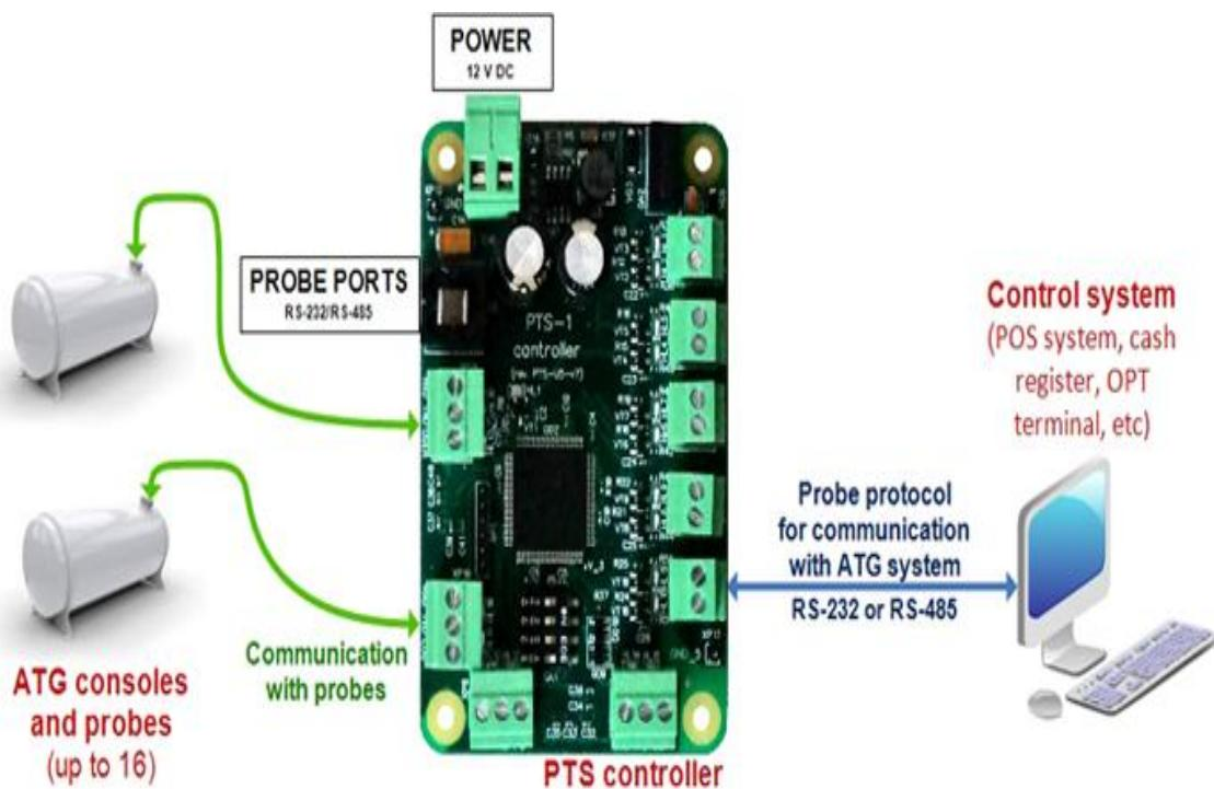
Slika 17: Shema funkcioniranja protokola sa ATG sustavima, Izvor:<sup>48</sup>
