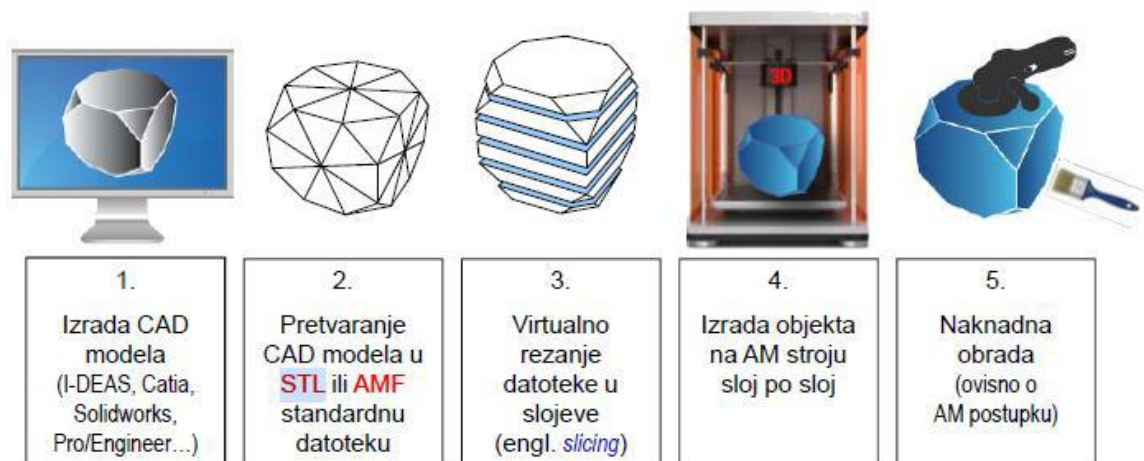
Slika 1. Postupak izrade 3D printanog modela
