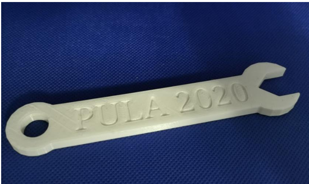
Slika 67. 3D printani prototip nakon završne obrade
