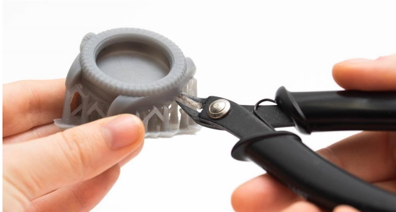
Slika 7. Uklanjanje potporne strukture
