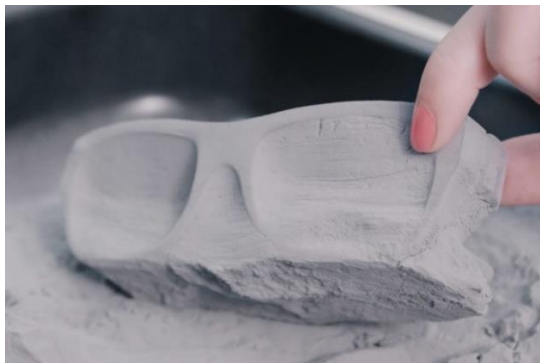
Slika 11. Uklanjanje praha koji se nije očvrstnuo
