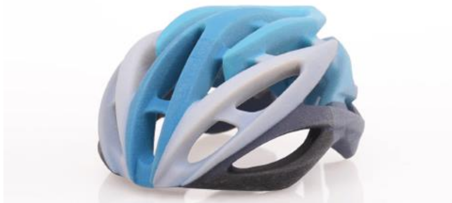
Slika 9. 3D objekt izrađen PolyJet postupkom
