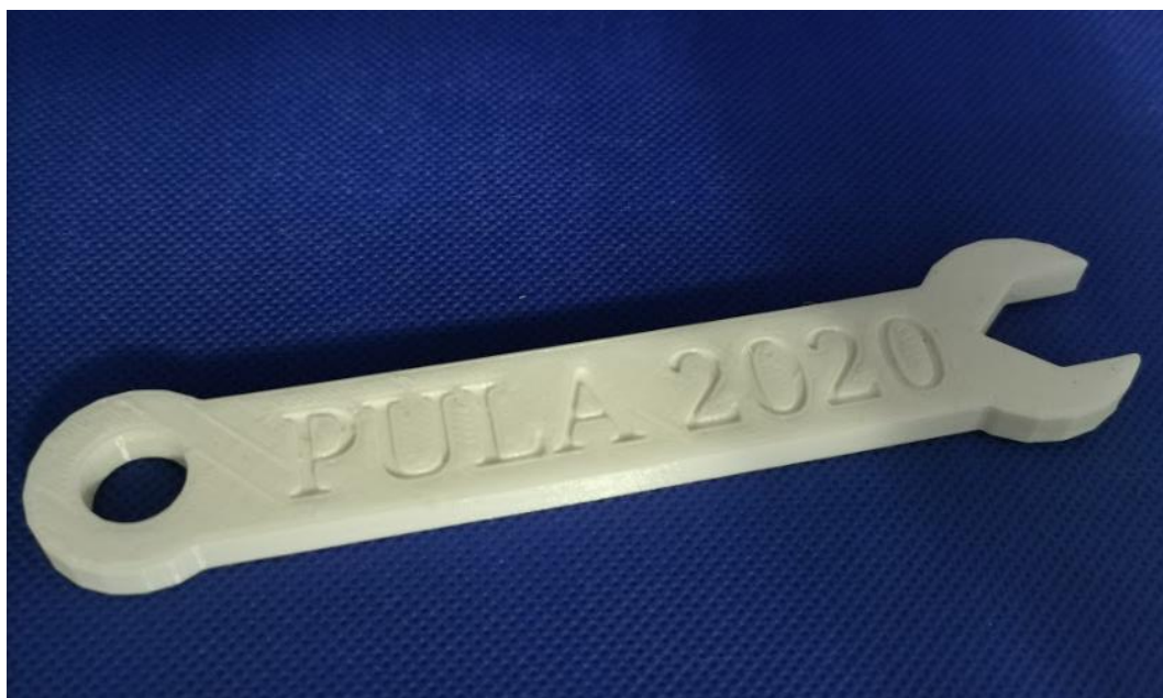
Slika 67. 3D printani prototip nakon završne obrade
