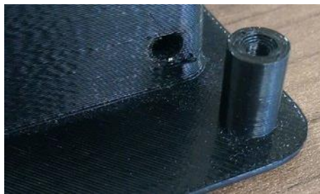
Slika 26. Izrada provrta kod FDM postupka
