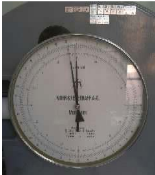
Slika 6.13.: Mjerni uređaj za mjerenje sile F koja djeluje na ispitne uzorke A i B [13]
