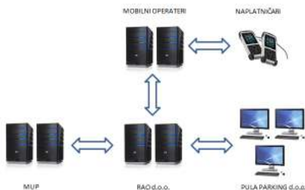
Slika 9: Shema sustava za pribavu podataka o vlasnicima vozila. Izvor: izradio autor.
