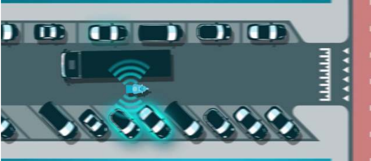
Slika 14: Prikaz skutera prilikom očitavanja registracija Izvor: https://www.scanacar.com/solutions/on-street/ (15.10.2017.)
