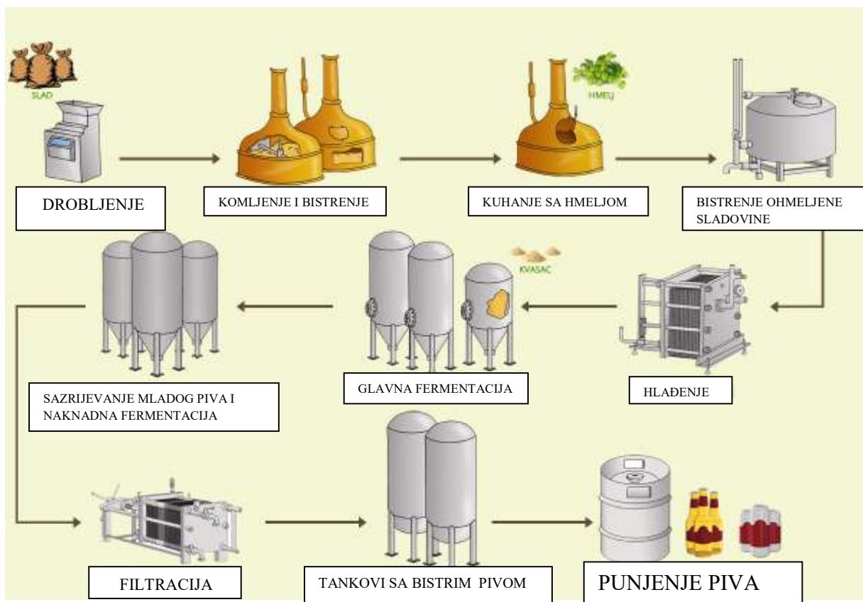
Slika 2. Shematski prikaz procesa proizvodnje piva<sup>16</sup>
