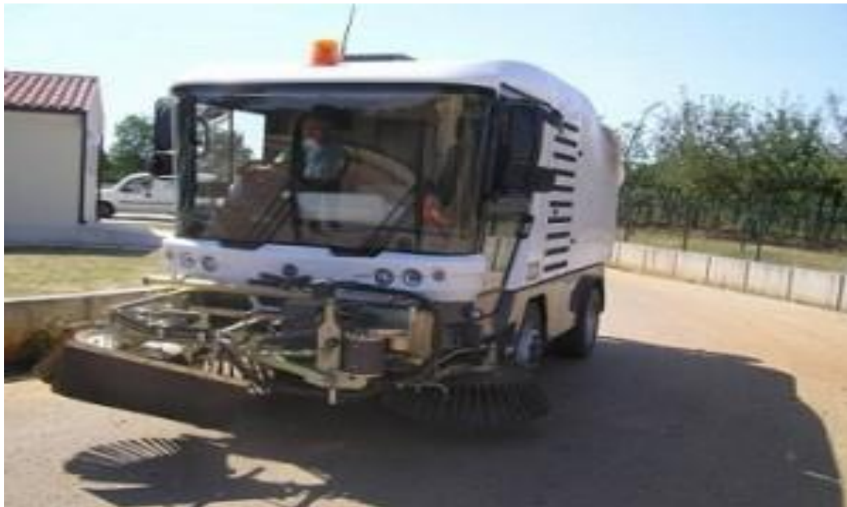
Slika 10: Čistilica za strojno pometanje
