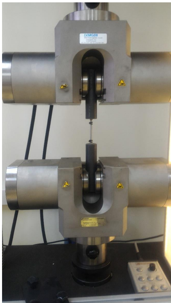
Slika 12. Epruveta postavljena u čeljustima hidraulične kidalice, spremna za ispitivanje
