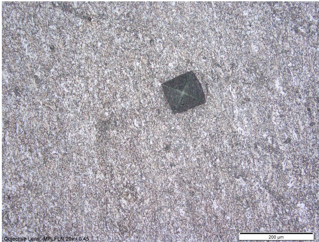
Slika 18. Uvećanje 200x čelika API 5L X80
