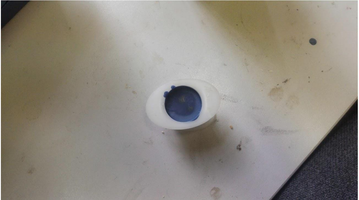
Slika 16. Kalup s polimernom smolom i čelikom
