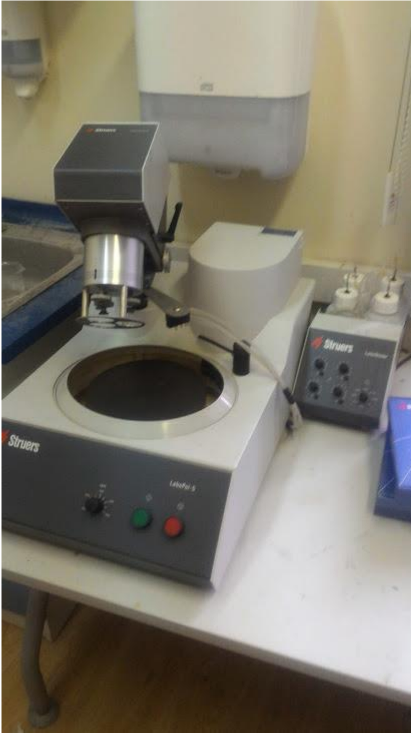
Slika 17. STRUERS LABOPOL-5 i LABODOSER
