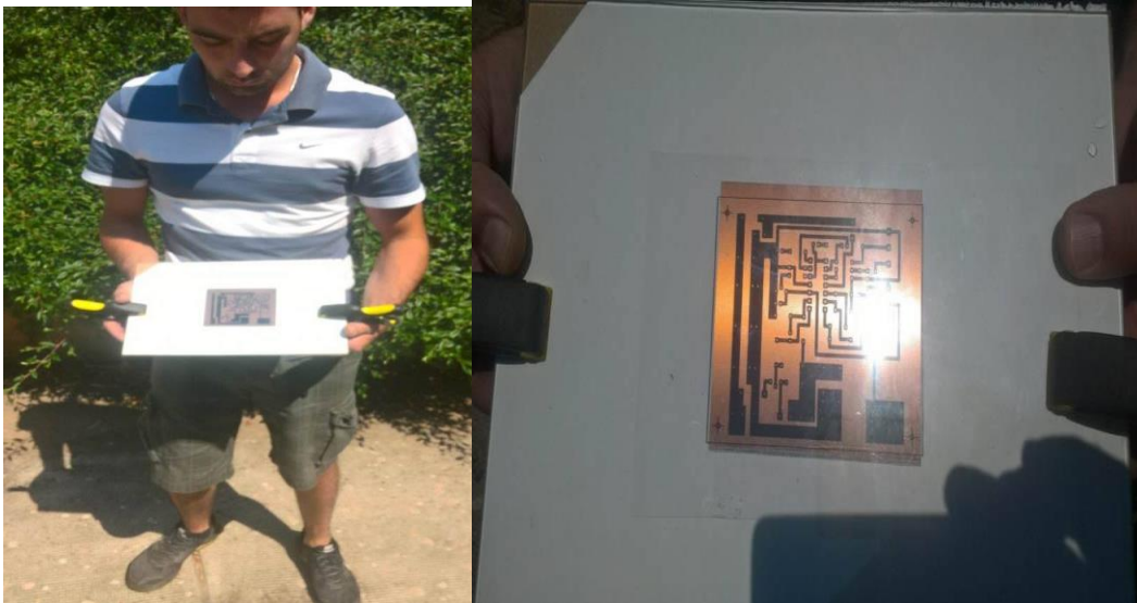
Slika 18: Osvjetljavanje pločice na suncu Izvor: Autor
